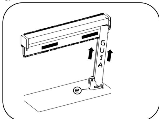
Encaja la guía a las pestañas que salen de las contratesteras en diagonal y colocala en su posición. Repetir la misma operación con la otra guía. Atornilla los cierres regulables al suelo o a pared
