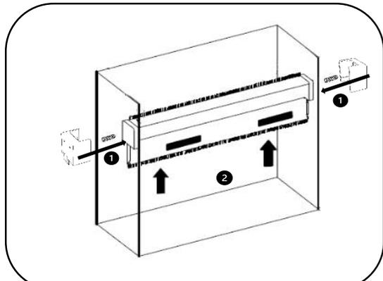
1 Montar las contratesteras con el muelle sobre la mosquitera prestando atención a que las pestañas para encajar la guía queden en la parte exterior.
